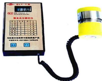
图 6 QLY-T 型水分测定仪图
