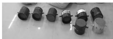
图1 养生结束的试件
